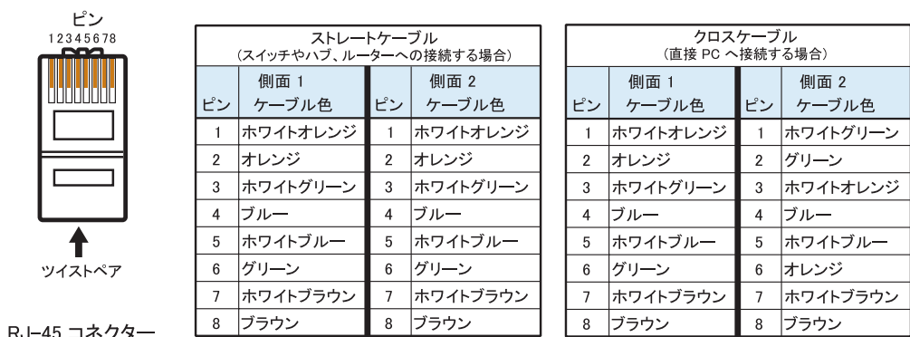
図 2-9 RJ-45 コネクタの終端処理
