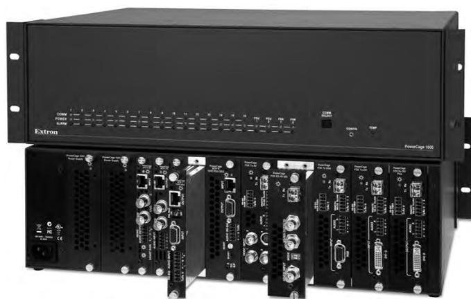
Extron PowerCage 1600 是一款可机架安装的紧凑型 16 插槽机箱，可容纳光纤和双绞线视音频发送器和接收器板，用于中长距离地传输低分辨率或高分辨率视频、立体声音频和 RS-232 控制信号。PowerCage 1600 设计适用于关键任务环境，它采用带可选冗余电源的热插拔、模块化设计以及有效的热量和功率管理，可最大程度地优化系统的可靠性。
