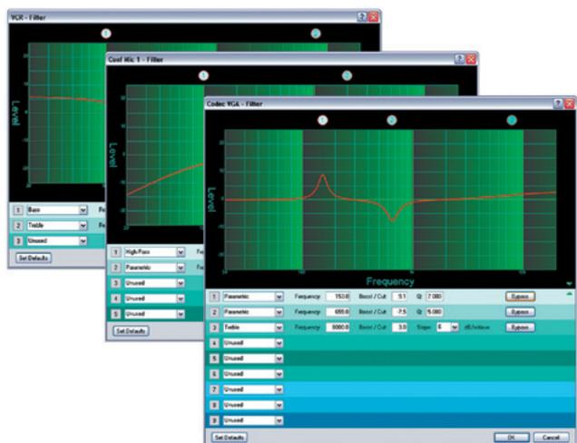
该滤波器模块为每一路线路输入提供了三种可自定义的滤波器, 为每一路麦克风输入提供了 5 个, 为 6 路输出中的每一路提供了 9 个。每个滤波器都可设置为参数均衡器、低通滤波、高通滤波, 或高低音均衡。标准的调整参数包括工作频率调整、斜率调整、提升/衰减以及 Q 值调整, 具体视特定滤波器而定。
