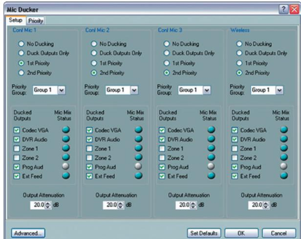
信号抑制 (Ducking) 模块是只要主麦克风处于工作状态, 就可通过自动降低其它麦克风和节目信号源的电平, 来对特定麦克风提供优先响应。信号抑制的设置, 是在一个独特的全局设置页面上完成的, 可用于所有的麦克风/线路输入。并备有广泛的信号抑制定制选项可供使用。
