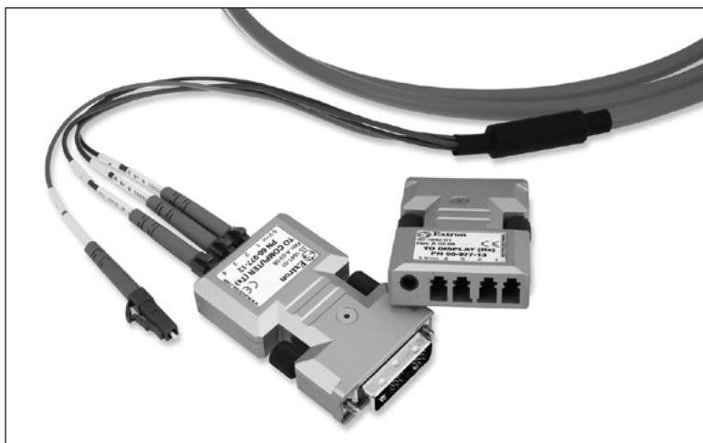
Extron DVI 104 光纤延长器是一组发送器和接收器，通过 4 根多模光纤，DVI 104 可以将单链路 DVI 信号传输至最远 500 m (1,640') 的距离。采用全数字技术，对分辨率高达 1920x1200 的计算机视频图像（包括 HDTV 1080p/60）进行完美的像素对像素的传输。
