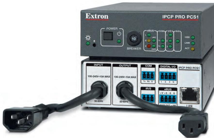
Extron IPCP Pro PCS1 是一款通用的高性能 IP Link Pro 控制处理器，带 AC 电源和设备控制。这款独特的控制处理器具有多个视音频控制端口，能够通过引线上的 IEC 连接器提供及管理设备电源。它的额定功率为 100-240 VAC、50/60 Hz，具有全球兼容性。该紧凑的 IPCP Pro PCS1 采用高级安全标准和千兆以太网，确保了在标准网络架构的基础上与多个 TouchLink® Pro 触摸屏相兼容。
