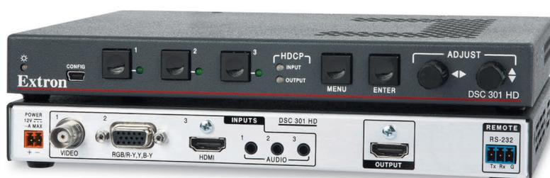
DSC 301 HD di Extron è uno scaler video compatto che accetta un'ampia gamma di formati video fra cui HDMI, HDTV, RGB e video a definizione standard. L'audio analogico proveniente da uno qualsiasi dei tre input stereo può essere inserito a scelta nell'output HDMI. Progettato per un'integrazione professionale, DSC 301 HD offre scaling e conversione del formato in un contenitore a basso profilo che consente di installare il prodotto in molti ambienti in maniera semplice e veloce.
