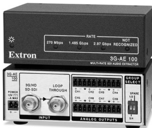
Extron 3G-AE 100 是一款用于 3G-SDI、HD-SDI 和 SDI 数字视频信号的高性能音频提取器。它可以对来自两个 SDI 音频组的多达 8 个通道的数字音频进行解嵌，并将其转化为线路电平模拟音频输出。3G-AE 100 包括一路 SDI 缓冲输入环通，可以对两个设备进行级联，以支持多达 16 个通道的嵌入音频。在需要从 3G-SDI、HD-SDI 或 SDI 信号中提取数字音频并转化为线路电平模拟音频的应用环境，3G-AE 100 无疑是理想之选。
