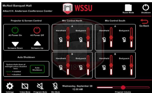
Mithilfe dieses Bildschirms können die Nutzer das AV-System an- und ausschalten, die Mikrofonpegel für die nördliche und südliche Seite des Raums steuern und die Leinwände hoch- und herunterfahren.
