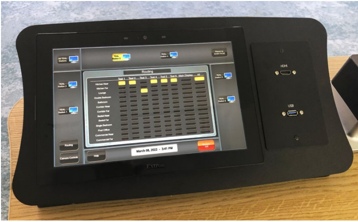
Der Dozent benötigt zur Steuerung des gesamten AV-Signalaroutings nur den Bildschirm des 10 Zoll großen TLP Pro 1025M TouchLink® Pro-Touchpanels am Pult.
