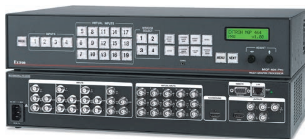
Der MGP 464 Pro-Multi-Grafikprozessor von Extron zeigt zwischen einem und vier Bildern in einer Vielzahl von Fensteranordnungen auf Flachbildschirmen oder Projektionsdisplays an.
