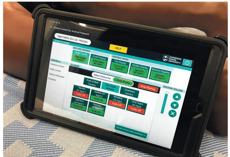
Le professeur peut contrôler le système audiovisuel de chaque station à partir d'une tablette disposant de l'application Extron Control. Le programmeur a utilisé la plateforme de programmation en Python Global Scriptor® Extron pour activer cette fonctionnalité et bien d'autres.
