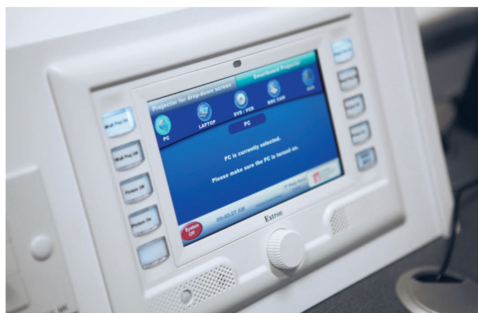
TLP 700MV de montaje en atril permite a los tutores manejar fácilmente el equipamiento AV de las aulas.
