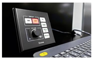
Il pannello a pulsanti eBUS collocato sui totem primari controlla selezione delle sorgenti AV, volume della soundbar e accensione/spegnimento del sistema. Il controllo è esteso ai totem secondari tramite collegamenti AV over IP professionali NAV sulla rete dell'Università.
