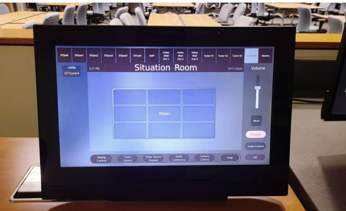
Der Krisenraum im EOC in North Carolina verfügt über mehrere Displays, einschließlich einer 3x3 großen Videowand mit seitlich angebrachten 96 Zoll großen Displays. Die AV-Signale von Quellen wie z. B. Computer mit spezieller Software, Newsfeeds und Geräten, die mit den Tischen verbunden sind, werden zu einem oder mehreren Displays gesendet. Alle Vorgänge werden mit einem 15 Zoll großen TouchLink Pro-Touchpanel am Haupttisch gesteuert.
