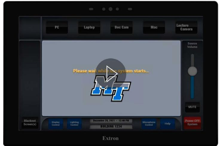
Das Logo füllt sich mit blau, der Schulfarbe der MTSU, um den Fortgang des Startprozesses des AV-Systems darzustellen. Klicken Sie auf das **PLAY**-Symbol für eine animierte Demonstration. Wenn der Startvorgang abgeschlossen wurde, können die Nutzer über die oberen und unteren Tasten wählen.
