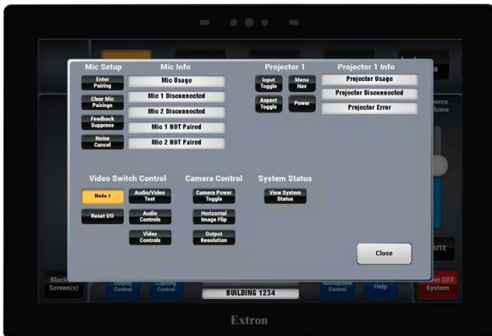
Start-Bildschirm der AV-Systemkonfiguration. Von diesem Bildschirm aus können die Techniker Bildschirme für Mikrofone, Audiofunktionen, Videofunktionen, Projektorfunktionen usw. einrichten.
