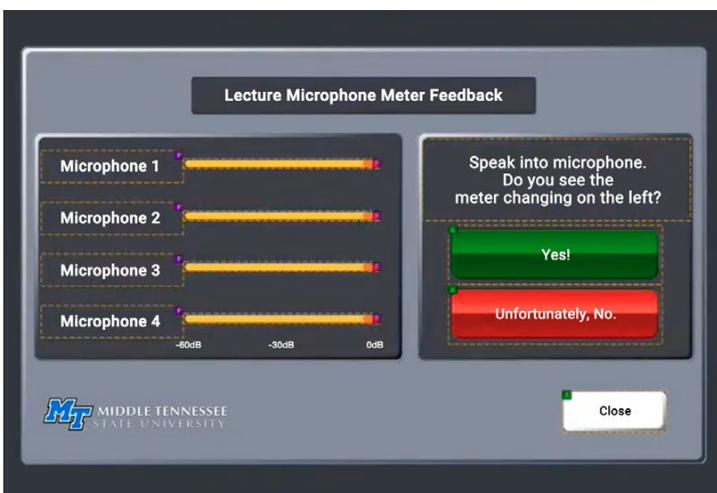
Bildschirm zur Fehlersuche beim Hörsaalmikrofon. Wenn das Makro zur Fehlersuche durchgeführt wurde, wird der Nutzer dazu aufgefordert, die Ergebnisse zu verifizieren und zu bestätigen.
