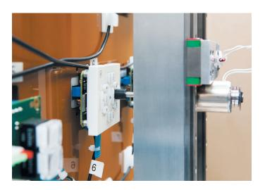
Un produit de contrôle est monté sur un support d'essai pour reproduire une configuration standard.
