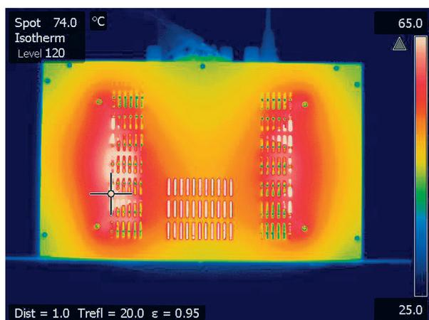
Обычные усилители выделяют значительный объём тепла и нуждаются в размещении отдельно от другого оборудования, чтобы предотвратить их перегревание. Есть вероятность в применении принудительного охлаждения.
