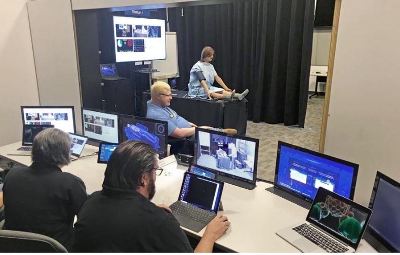
Das Testen der Konzeptfunktionalität beinhaltet einen umfangreichen externen Demonstrationsaufbau der geplanten Labore. Jeder Aufbau verfügte über ein technologiegestütztes Workstation-Bett oder eine Behandlungsstation und einen Steuerungsraum mit allen Möglichkeiten zur Steuerung der Überwachung, des Betriebs und der Kommunikation.
